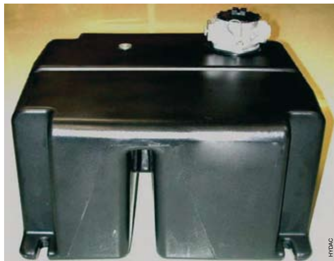
Hydrauliktanks aus Kunststoff: lassen sich platzsparend in vorhandene Fahrzeugkonstruktionen einpassen, Schwappschutzwände inklusive. Kunststofftanks von HYDAC sind absolut dicht: Öffnungen wie z.B. für den Anbaufilter sind zusätzlich mit einem eingegossenen Aluminiumring versteift – ein Patent von HYDAC.
