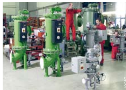
Optimierte Fertigungsprozesse für innovative Prozesstechnik: Die großzügig dimensionierten Fertigungshallen bieten Platz für überschaubare und schnellere Abläufe bei der Produktion der Produkte, z.B. der automatische Rückspülfilter AutoFit RF3 – der Renner unter den Filtern für die Verfahrenstechnik.
