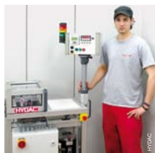
M. Groß, der erste Auszubildende der HYDAC im Beruf Mechatroniker neben seiner erfolgreichen Abschlussarbeit, einer teilautomatisierten Einstell- und Prüfanlage für Druckschalter. Mit dieser und seinen sonstigen Leistungen ebnete er sich damit auch den Weg zur Übernahme bei HYDAC Fluidtechnik.
