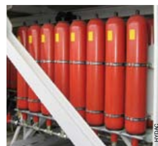
Energie auf Abruf: Speicherstation für die zuverlässige Unterstützung der hydraulischen Kreisläufe der Bohranlage.
