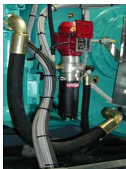
Nebenstromfilter OLF (links) und NF (rechts) im Einsatz an Windkraftanlagen
