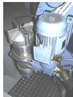
Nebenstromfilter OLF (links) und NF (rechts) im Einsatz an Windkraftanlagen
