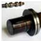
Tiroir de valve avec dépôts
