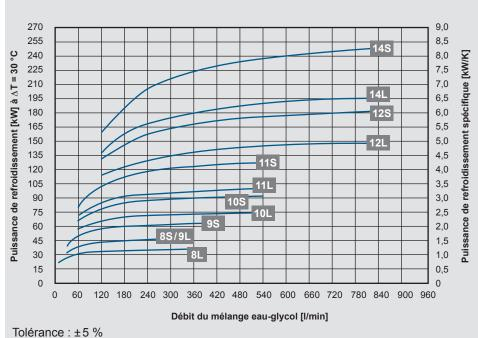
Puissance de refroidissement : En fonction du débit du mélange eau-glycol et de la différence de température ΔT entre l'entrée eau-glycol et l'entrée d'air.
