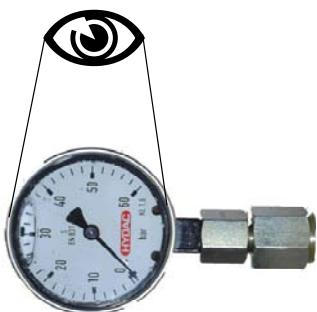
Stellen Sie den Druck bei maximaler Viskosität des Betriebsmediums auf ca. 25 bar ein.
