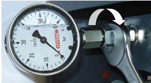
Den Adapter mittels dem Maulschlüssel SW 22 leicht anziehen.
