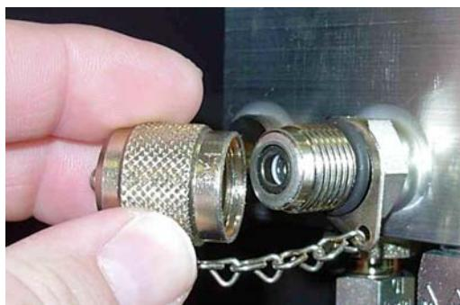
Verschliessen Sie beide Messanschlüsse 1 + 2 mit Hilfe der anhängenden Staubkappe.
