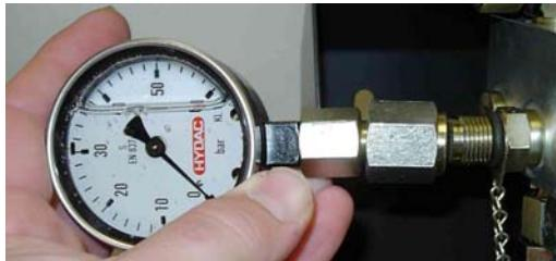
Verbinden Sie das Manometer mit dem Messanschluss 1.
