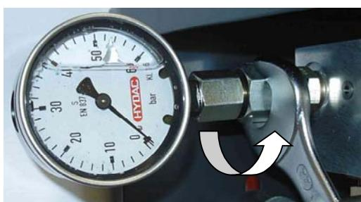
Entnehmen Sie das Manometer vom Messanschluss 1 und schliessen Sie es an Messanschluss 2 [C] an.
