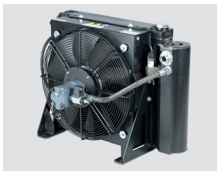
Refroidissement d'huile sur les pompes à béton : refroidisseur à air avec moteur hydraulique et filtre intégré
