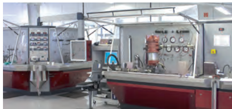
Bara ett exempel på alla de olika filterprovningssmetoderna: Multipasstest-provstation.
