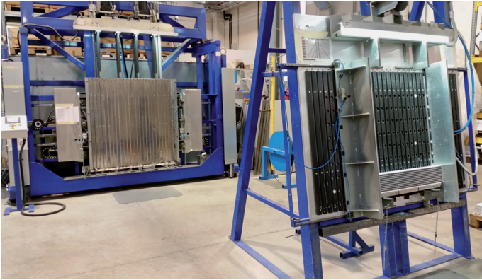
Assemblage de l'élément de refroidissement
