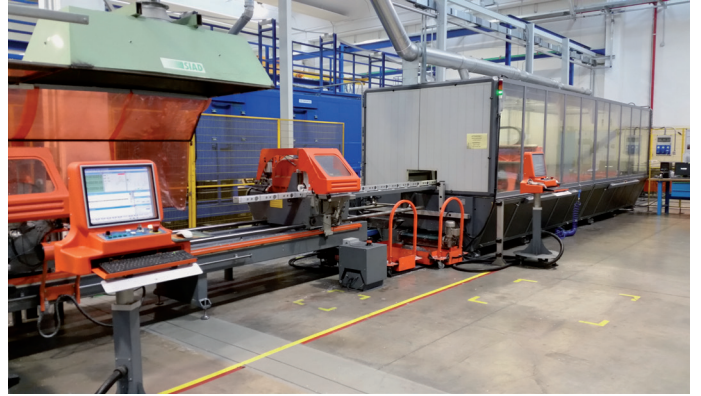
Usinage CNC des collecteurs
