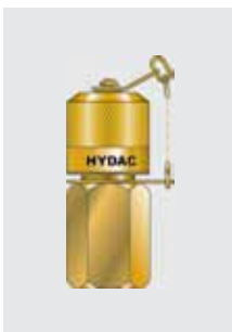
Manchon de mesure SAEJ 514 à portée conique 37°
