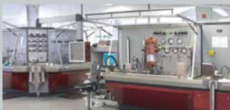
Nur ein Beispiel der zahlreichen Filterprüfverfahren: Multipasstest-Prüfstand.
