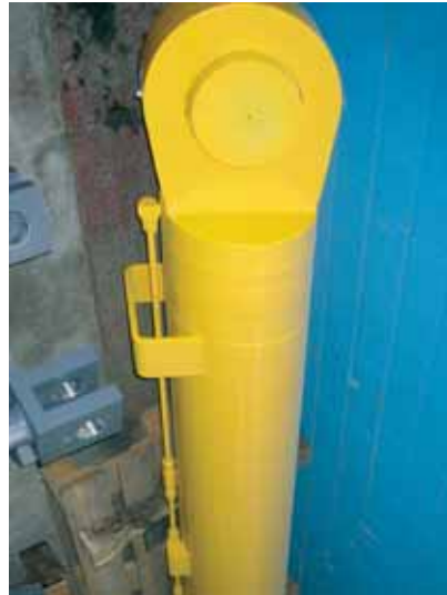
Zylinder mit Hub: 4 m, Gewicht: 8 t
