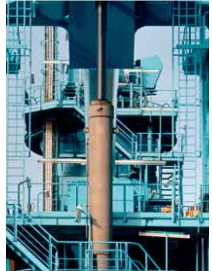
Zylinder mit Hub: 6 m, Gewicht: 14 t
