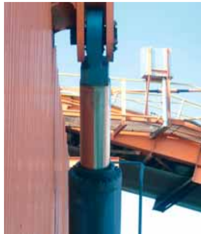
Zylinder von HYDROSAAR bestehen auch die aggressiven Einflüsse von Salzwasser, Seeluft, Schmutz und Staub.
