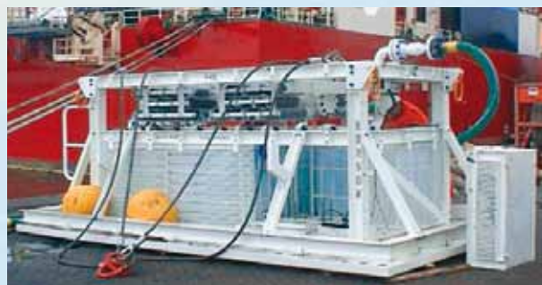
Filtration fine d'eau salée avec bougies filtrantes spécifiques à usage unique .
