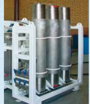
Station d'accumulateur en inox dans unité haute pression.
