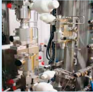
Accumulateur à membrane utilisé comme amortissement de coup de bélier pendant l'utilisation de la vanne de commande. Volume de 0,075L à 4L et une pression jusqu'à 1,000 bar / 14,500 PSI.
