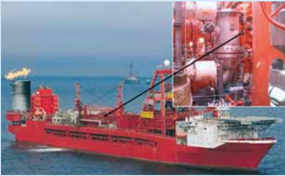
Plateforme de production flottante / FPSO (floating production storage and offloading). Amélioration de la propreté de l'eau produite à l'aide d'un filtre à rinçage par contre courant automatique Autofilt® RF3 (débit 800 m 3 /h).
