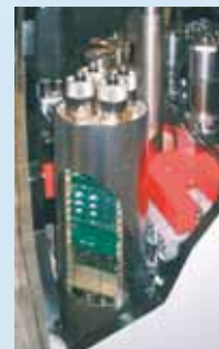
Filtre en inox dans module sous marin.
