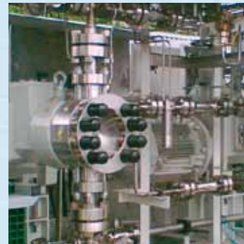
Compresseur au méthanol utilisant un filtre haute pression en INOX HPSSF , 690 bar / 10,000 PSI.
