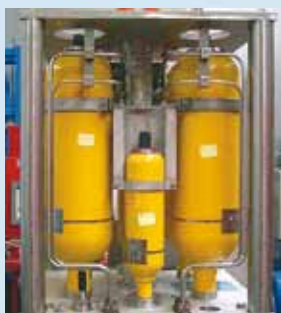
Accumulateur haute pression suffisant pour fournir une capacité de 100% dans le manègement de la soupape.
