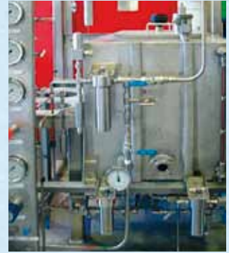
Filtre haute pression en inox HPSSF dans unité haute pression HPU, jusqu'à 690 bar / 10,000 PSI.
