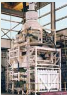
Station d'accumulateur dans BOP.
