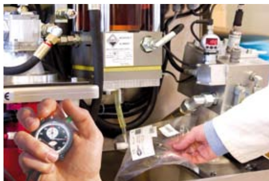
Einfache Gasentnahme zur Bestimmung der Gasbildungsrate.
