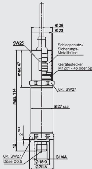
Die Schlagschutz-/ Sicherungsmetallhülse ist im Lieferumfang enthalten. Für den elektrischen Anschluss ist eine gerade Kupplungsdose erforderlich. Z.B. Kupplungsdose M12x1, 4-pol, gerade mit 3m Leitung geschirmt: ZBE 06S-03, Mat. Nr. 6098243
