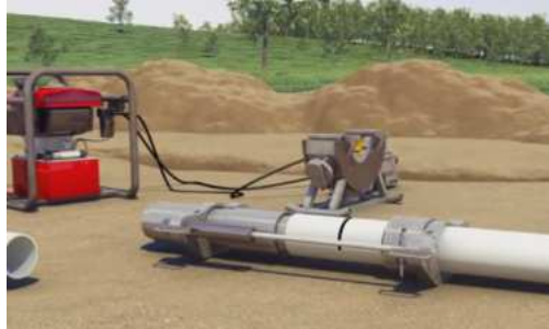
▪ Darstellung Schritt 1: Hülse aufschieben
