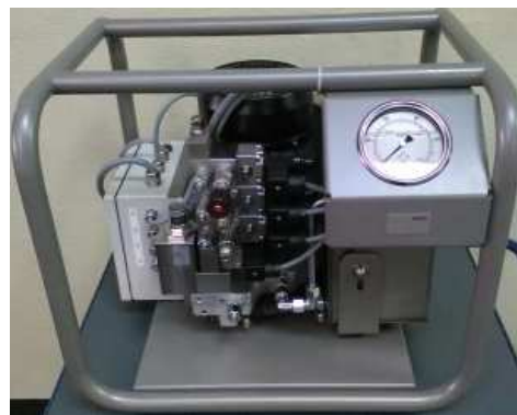
▪ BIERI Hochdrucksystem: Anwendungsspezifisches Kompaktaggregat Bauart BKA
