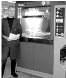
Qualitätsprüfungen leicht gemacht: Eine Person kann die Oberflächen-sauberkeit am 220-kg-Zylinderkurbelgehäuse analysieren.
