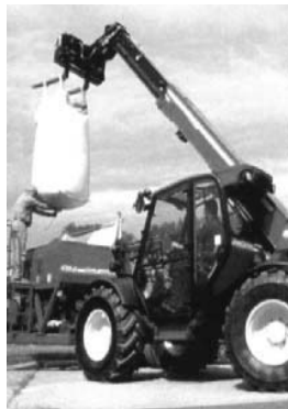
Patentierter Sicherheit: Das hydropneumatische Federungssystem verhindert unkontrollierte Lastbewegungen am Teleskoparm.
