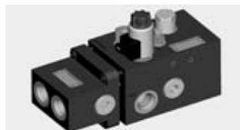
Qmax: 160 l/min, p: 350 bar, Δp: 8 bar, Pst: 25 bar, Anschlüsse ISO-6149, A/B/T: M 27 x 2, L: M 18 x 1,5, X: M 14 x 1,5
