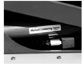
Sicherheit geht vor: HYDAC Notablassventil als Bestandteil der Hebebühnentechnik.
